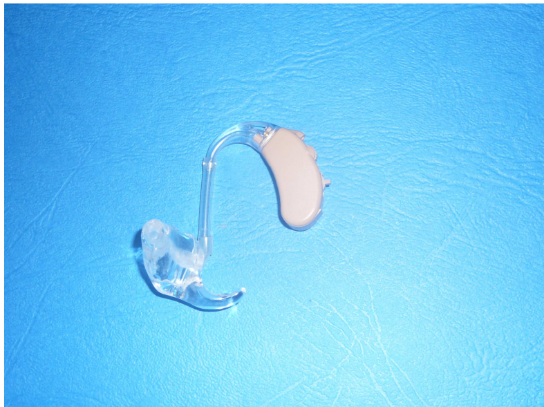
Obr. 1: sluchadlo závěsné s individuální tvarovkou. Tvarovka je základem úspěchu – bez dobré tvarovky nelze mít úspěšný poslech. Hodí se i pro velmi těžké ztráty sluchu.
