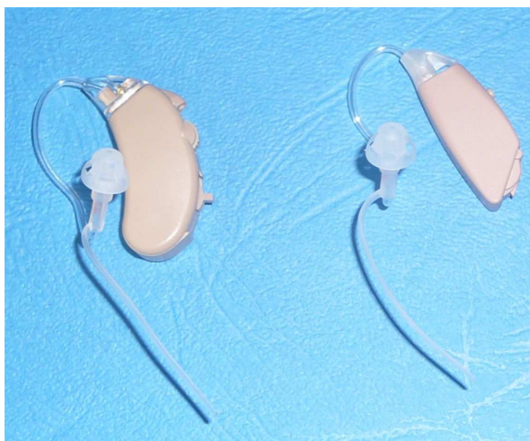
Obr. 3: sluchadlo s otevřeným systémem – miniaturní závěsné sluchadlo
